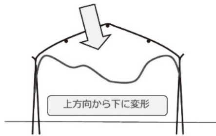
真上から屋根が押しつぶされたように陥没
